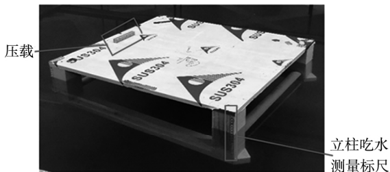
图 17 3、4 号柱之间的工况 2 (纵倾) 压载
