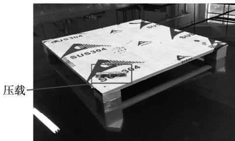
图 18 1 号柱上方的工况 3 (任意倾斜) 压载
