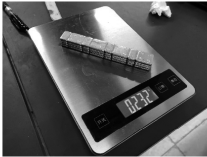
图 15 测量压载的质量
